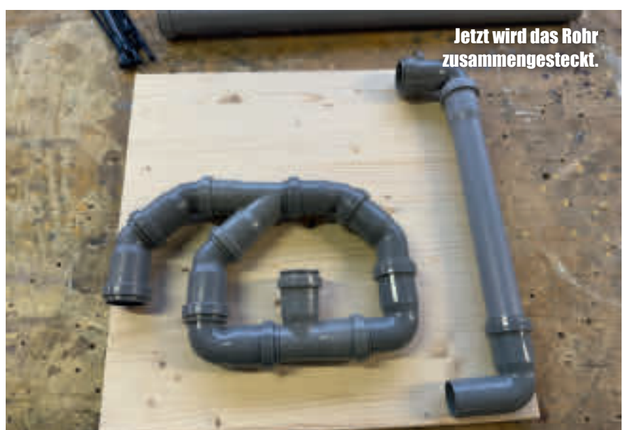
Etwas Rohr, ein paar Bögen. T- und Y-Teile, eine Schraube und Kabelbinder sind die wesentlichen Teile für das Versteck.
